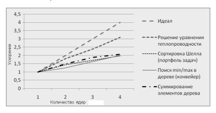
Ускорение, достигнутое при решении ряда задач на многоядерной системе
